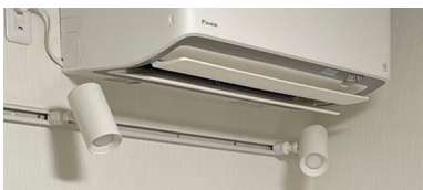
図4 制作した入居者配慮型ライティングレール対応サーマルカメラ Fig. 4 Thermal camera for lighting rails designed for resident comfort.
